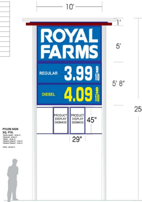
1 PYLON SIGN ELEVATION SCALE: 1/2" = 1'-0"
